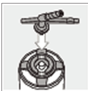
рис.2. Вставьте насадку -распылитель в баллон
