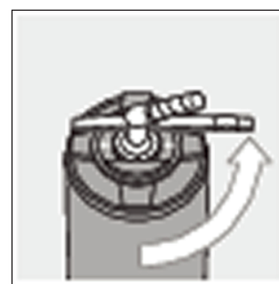
рис.3 Поверните насадку -распылитель против часовой стрелки и зафиксируйте ее.
