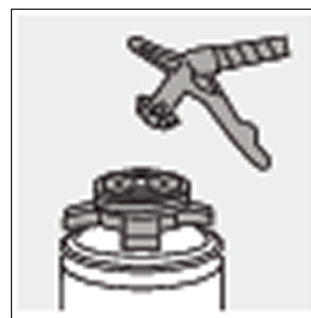
Насадка-распылитель AA 210 легко монтируется в баллон. рис.1 Снимите защитный клапан с баллона.
