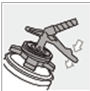
рис.4. Баллон готов к работе . Нажмите на пусковой курок.
