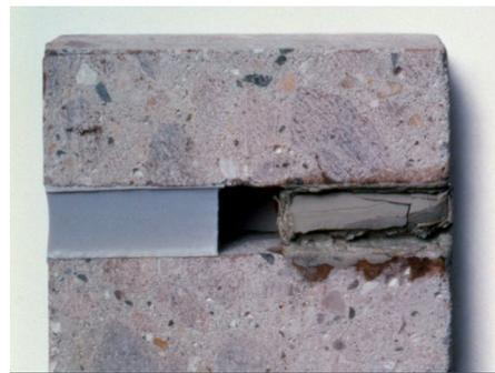
Силиконовый герметик DOWSIL™ (слева) и лучший полиуретановый герметик после 2500 часов испытаний в условиях повышенной влажности и ультрафиолетового облучения в ходе углубленного тестирования образцов на атмосферную и температурную стойкость и стабильность
